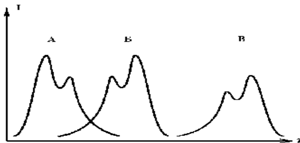
Рис. 6.28. Спектры поглощения (А), флуоресценции (Б) и фосфоресценции (В) одного соединения
