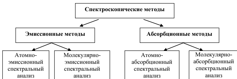
Рис. 6.10. Классификация спектроскопических методов
